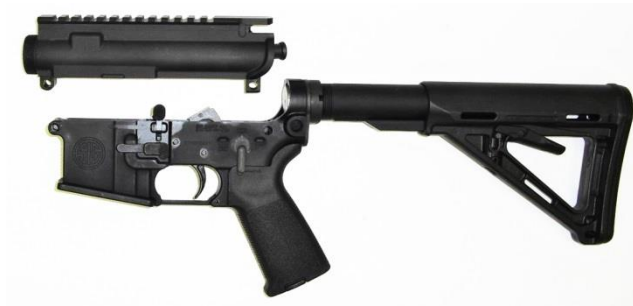
Abbildung 4 Aufteilung eines Gewehres Colt AR 15 in Gehäuseoberteil und Gehäuseunterteil, allgemein auch als Griffstück bezeichnet.
