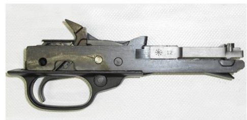
Abbildung 8 Baugruppe Abzug einer Winchester Vorderschaft-Repetierflinte. Da es sich um eine Repetierwaffe handelt, ist die Baugruppe Abzug kein unteres Gehäuse und damit auch kein wesentliches Waffenteil .
